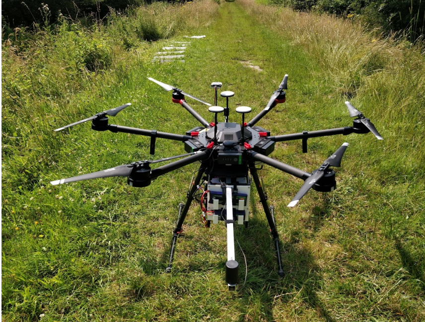
Figuur 2.3: De Matrice 600 Pro multicopter, foto: Todi Daelman.
