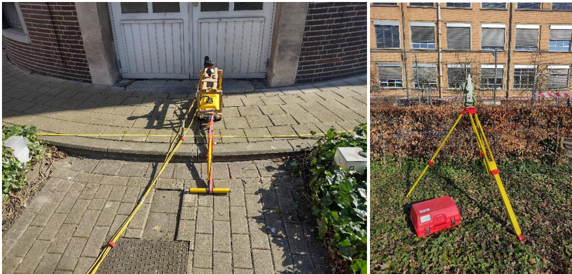
Figuur 3.19: Proefopstelling Coupure Links: grondradar Sensors & Software (links), totaalstation (rechts).
