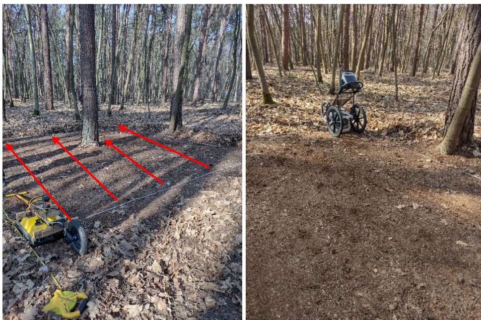
Figuur 3.22: Proefopstelling Bosland: grondradar Sensors & Software met aanduiding van de richting van de gemeten transecten (rode pijlen) (links), en de GSSI-grondradar (rechts).
