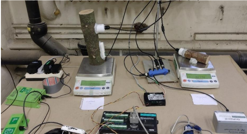
Figuur 3.35: Proefopstelling kalibratie voor een tak van de esdoorn (links) en den (rechts).
