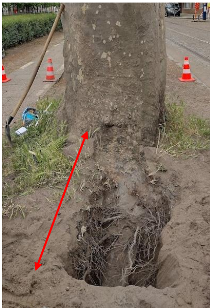
Figuur 4.8: De boomwortel werd uitgegraven tot een afstand van ongeveer 1,10 m van de boom (links). De diepte van de dikke boomwortel werd geschat tussen de 75 en 80 cm (rechts).
