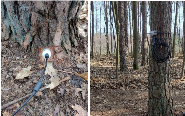
Figuur 3.15: Opstelling en onderdelen van de HydraGO Field Version sensor. De eerste sensor werd loodrecht bevestigd in de boom en de tweede sensor werd verticaal in de bodem dicht bij de boom bevestigd. De logger en kabels van de sensor werden rond de boom bevestigd.
