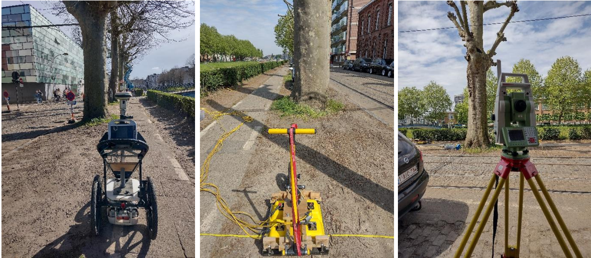
Figuur 3.17: Proefopstelling Coupure Rechts: GSSI-radar met GPS (links), grondradar van Sensors & Software (midden) dat gebruik maakt van een totaalstation (rechts).
