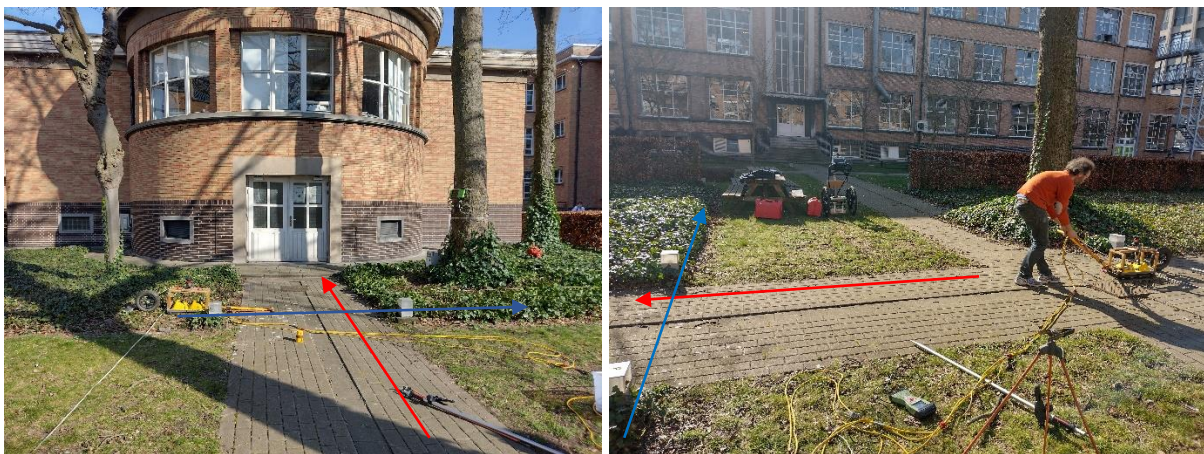
Figuur 3.20: Proefopstelling Coupure Links met aanduiding van de twee richtingen (rode en blauwe pijl) waarin gemeten werd.
