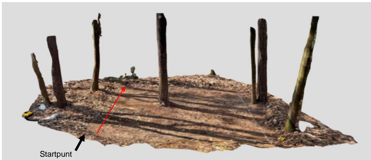
Figuur 3.21: 3D-visualisatie van de proefopstelling in Bosland, met aanduiding van het startpunt (zwart pijl) en de richting (rode pijl) van de radartransecten.
