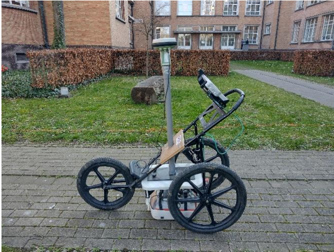
Figuur 3.12: Radaropstelling GSSI UtilityScan DF. Onderaan de driewielige buggy is de GPR bevestigd. Op de computer worden de instellingen bepaald en worden de profielen onmiddellijk weergegeven. Bovenaan is de GPS (Leica GS15 Performance) bevestigd en deze is geconnecteerd met de computer. De afgelegde afstand wordt bepaald door de odometer die bevestigd is aan het wiel van de buggy.
