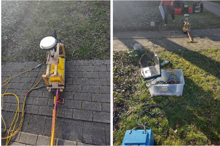
Figuur 3.13: Radaropstelling pulseEKKO PRO (500 MHz). Bovenaan de radar wordt de GPS (Leica GS15 Performance) of een prisma (voor het totaalstation) bevestigd. De bekomen data wordt verzameld via de software SpiView via de computer.
